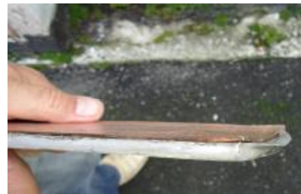
Рисунок 2 – Полученные плакированием взрывом слоистые медно-алюминиевые композиции
