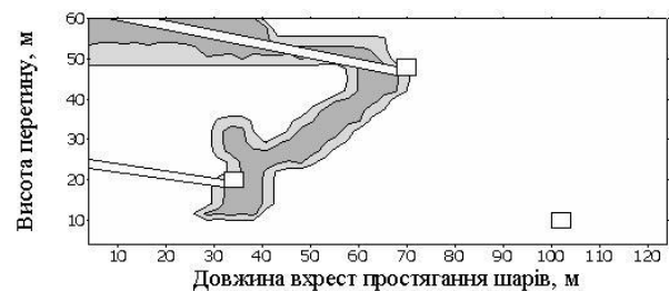
Рисунок 4 – Розподіл зон поза межних деформацій поблизу міжшахтного цілика при веденні очисних робіт (на прикладі шахти «Донецька», пласти l_3 і l_4 )
