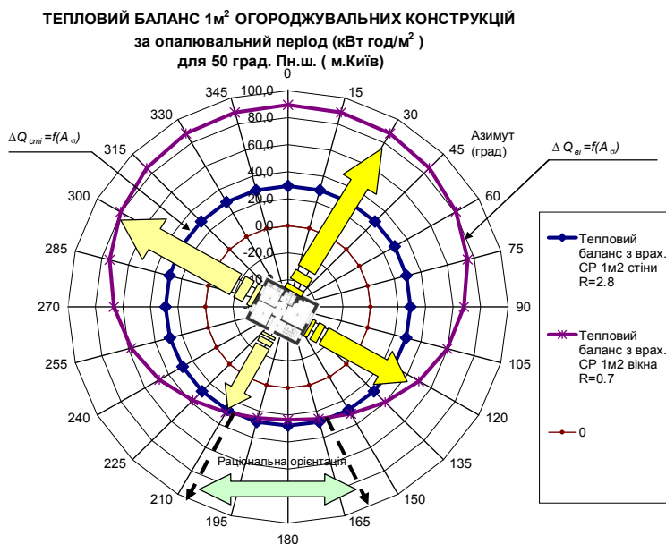
Рисунок 2 – Визначення раціональної орієнтації світлопрозорих конструкцій з використанням моделей \Delta Q_{ст} = f(A_{ст}) та \Delta Q_{в} = f(A_{в}) теплового балансу світлопрозорих і непрозорих огорожувальних конструкцій
