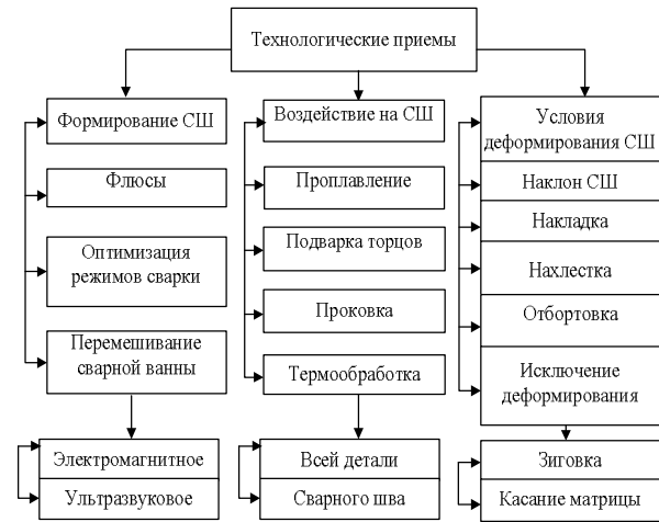
Рисунок 1 – Блок-схема технологических приемов, повышающих штампуемость сварных заготовок
