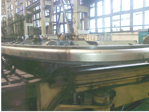
Рисунок 2 – Гибочно-растяжной станок в процессе гибки дуги пассажирского вагона
