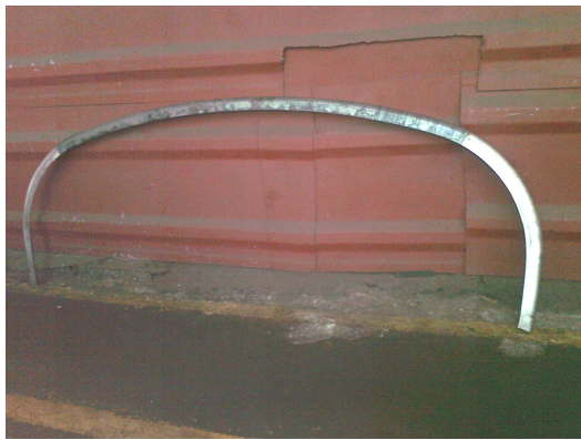
Рисунок 4 – Дуга пассажирского вагона из разнородных металлов после гибки с растяжением
