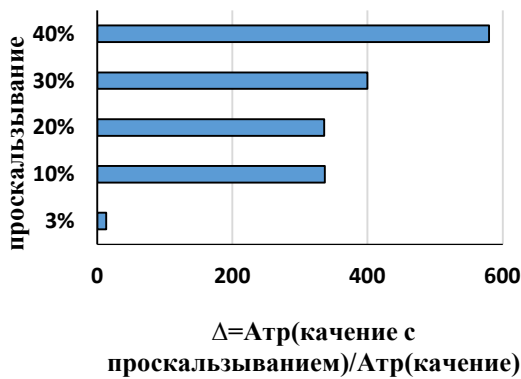
Рисунок 8 – Кинетика изменения удельной работы трения на участке II при проскальзывании 3 % (1), 10 % (2), 20 % (3), 30 % (4), 40 % (5)(а) и приращение A_{тр} в условиях проскальзывания относительно чистого качения (б)
