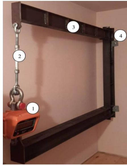
Рисунок 4 – Фотоизображения экспериментальной установки для диагностики НДС ФП МК: 1 – крановые весы промышленного образца ТОН-3; 2 – талреп грузовой вилка-вилка М22; 3 – экспериментальный образец; 4 – крепление
