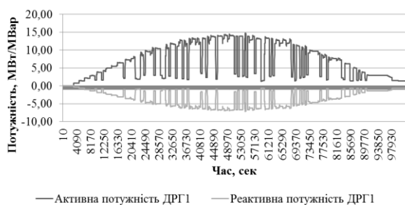
Рисунок 8 – Зміна потужності ДРГ в режимі \cos\varphi = \text{const}
