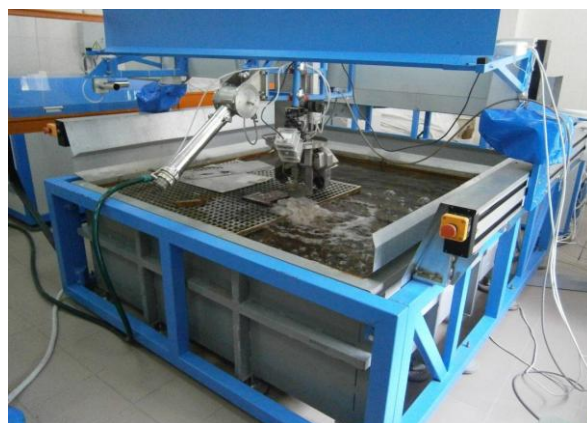
Рисунок 4 – Установа струминного впливу для керованого руйнування поверхонь (довжина хвилі променя 1062 нм, середня потужність випромінювача 410 Вт, частота імпульсів 50–1000 Гц)
