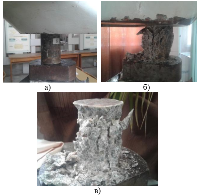
Рисунок 5 – Разрушение полимербетонного образца а) – положение образца в рабочей зоне испытательной машины EDZ-100; б) – процесс разрушения полимербетонного образца; в) – вид полимербетонного образца после разрушения
