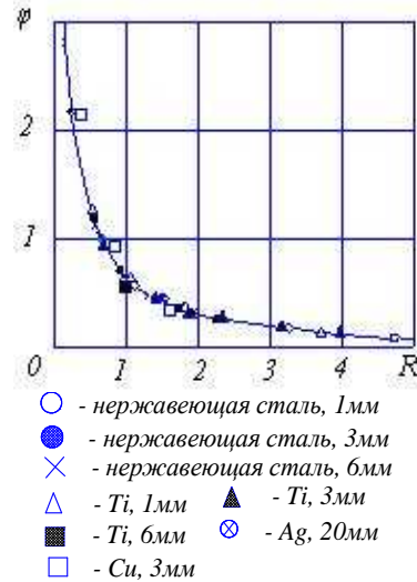
Рисунок 6 – Коэффициент спада давления продуктов детонации ВВ в функции от отношения массы ВВ к массе поршня (точки - экспериментальные значения)
