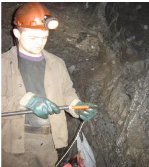
Рисунок 5 – Фото установки ДПМ в зарядный шланг
