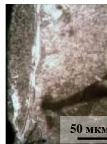
Рисунок 5 – Мікроструктура поверхневого шару зразка VT1-0, хімічне травлення – плавикова кислота у гліцерині, ЕІЛ на повітрі: анод – Al; I = 1,8..2 А; V = 60..80 В; τ = 300 с (5 хв), наступна ЛО: Wp=2,6 ГВт/м 2
