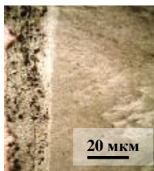
Рисунок 1 – Структура нетравленого зразка титанового сплаву VT1-0, ЕІЛ на повітрі: анод – Al; I = 1,8..2 А; V = 60..70 В; τ = 180 с (3 хв)
