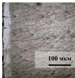
Рисунок 7 – Структура поверхневого шару зразка BT1-0, ЕЛП на повітрі: анод – Al; I = 1,8..2 А; V = 60..80 В; \tau = 180 с (3 хв) наступна ЛО: W_p = 5 ГВт/м 2
