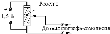
Рисунок 5 – Електрична схема підключення датчика переміщення
