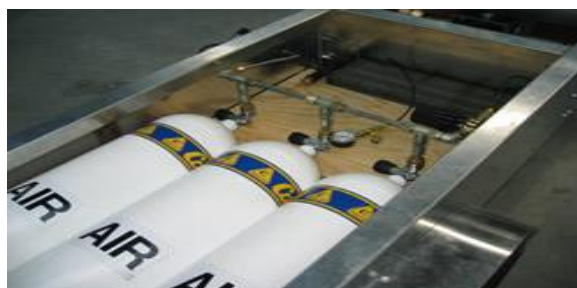
Рисунок 2 – Розміщення автономного джерела живлення на переобладнаному транспортному засобі
