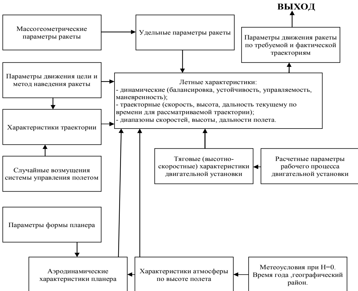
Рисунок 2 – Формализованная схема математического моделирования летно-технических характеристик ракет
