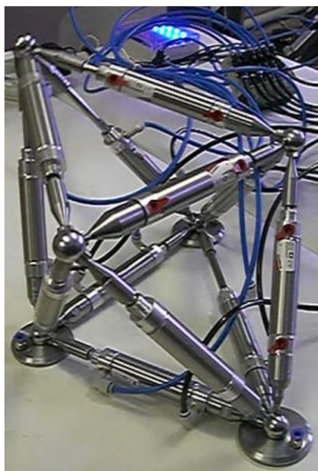
Рисунок 14 – Просторова триангулярна структура, яка має дванадцять приводів і шість шарнірів
