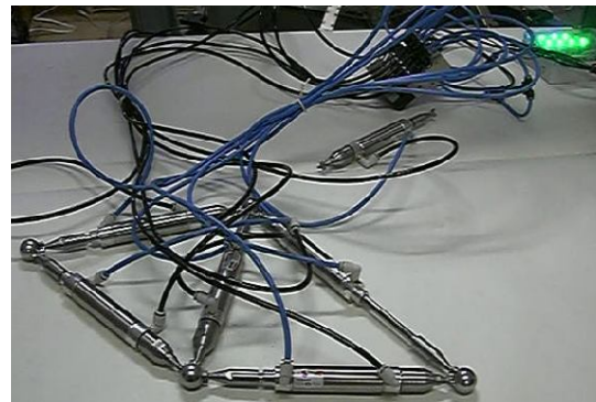
Рисунок 11 – Триангулярна структура, яка має п'ять приводів та чотири сферичні шарніри
