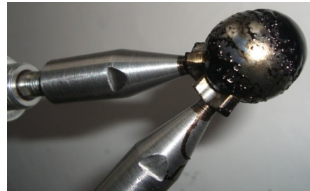
Рисунок 6 – Взаємодія магнітної сфери із опорними поверхнями хвостовиків при наявності феромагнітної рідини
