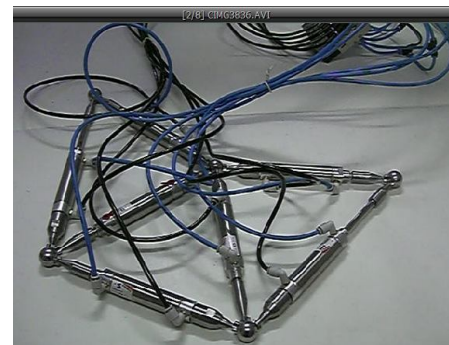
Рисунок 12 – Дослідний зразок лінійної триангулярної структури, що включає сім приводів і п'ять сферичних шарнірів
