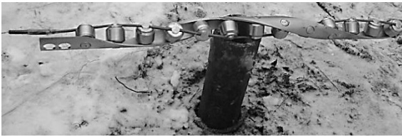
Рисунок 3 – Пристрій МПКВ (без порохових зарядів), підготовлений до стендових випробувань
