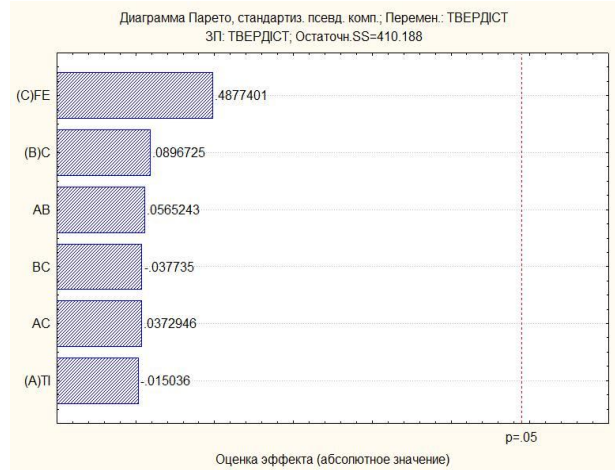
Рисунок 4 – Діаграма Парето для зразка системи Ti-C-Fe з 3-ма компонентами для твердості
