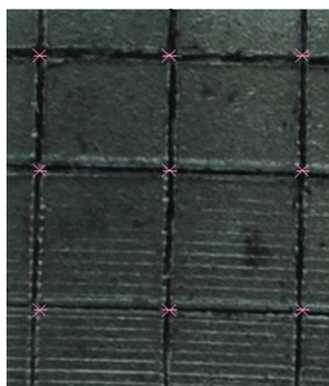
Рисунок 6 – Разметка узлов на образце № 2
