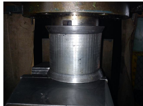
Рисунок 2 – Заготовка з нанесеною на неї координатною сіткою в момент роздачі
