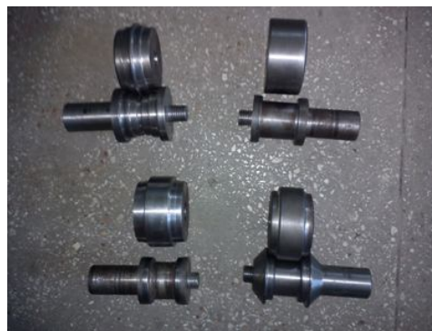
Рисунок 3 – Ролики для обкатки заготовок
