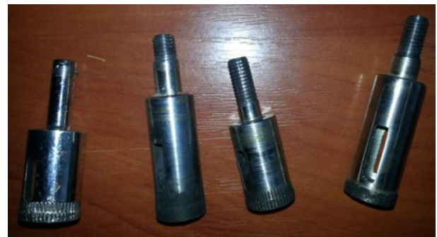
Рисунок 3 – Використовувані для обробки вуглець-вуглецевих композицій кільцеві свердла
