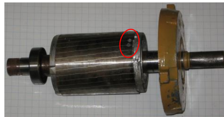
Рисунок 2 – Ротор АД з пошкодженням стрижнів
