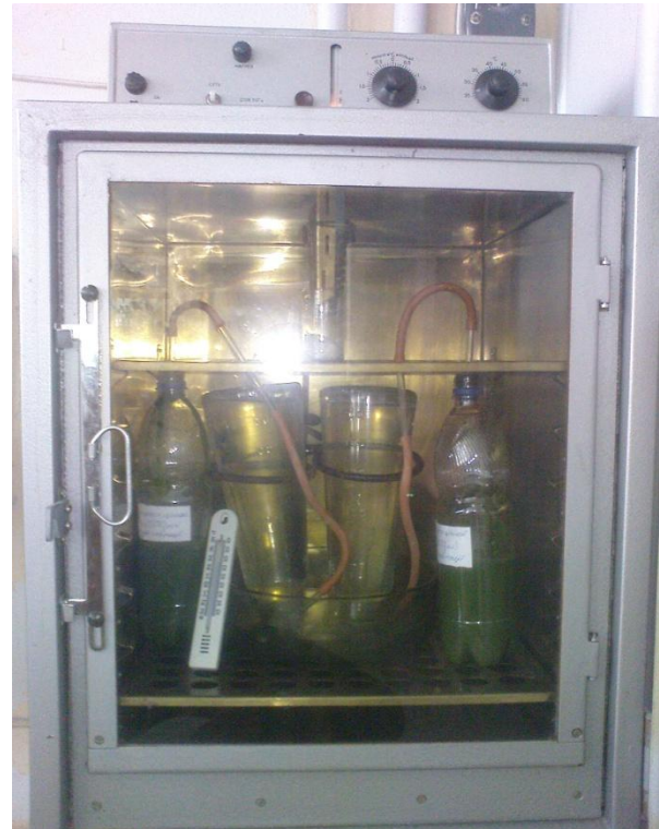
Рисунок 2 – Лабораторна метаногенна установка
