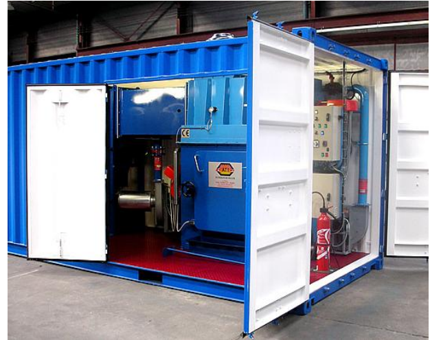
Рисунок 1 - Піч-інсинератор CP-50 Mobile «ATI Incinerateurs MULLER»
