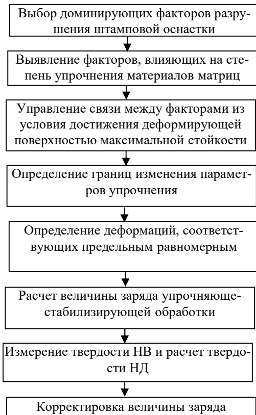
Рисунок 3 – Этапы разработки методов управления структурой и свойствами гравюры и материала матриц
