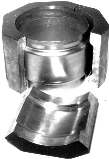
Рисунок 4 – Готовая деталь в разрезной матрице, состоящей из четырех формующих элементов
