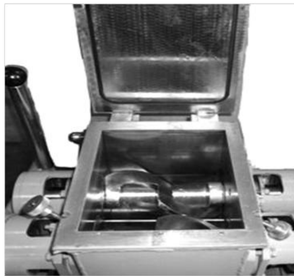
Рисунок 3 – Камера змішувача СРК- 3,5 з Z-подібними лопатями
