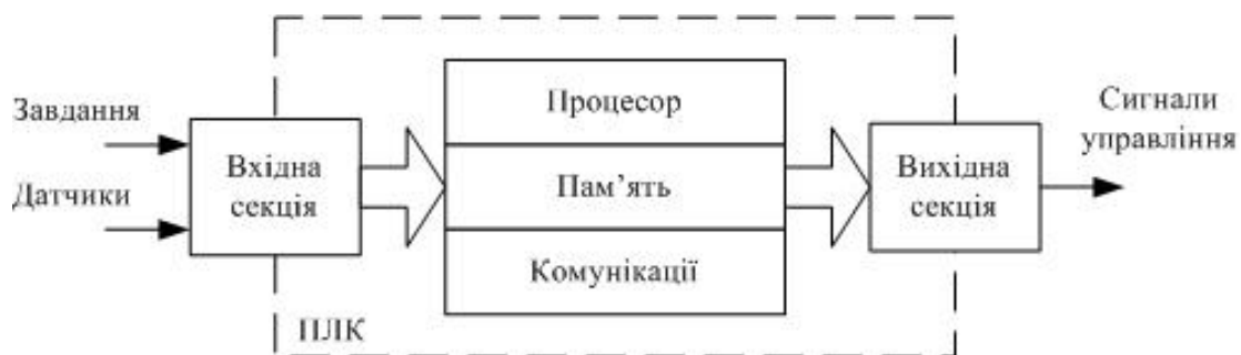
Рисунок 2 – Функціональна схема ПЛК
