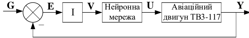
Рисунок 1 – Структурна схема багатовимірної системи автоматичного управління авіаційного двигуна ТВ3-117
