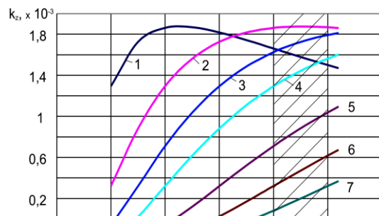
Рисунок 5 – Залежність коефіцієнта k_z від довжини транспортувальної поверхні ( R=0,1 м; \omega_1=0,008 рад/см): 1 – x=5 мм; 2 – x=10 мм; 3 – x=15 мм; 4 – x=20 мм; 5 – x=30 мм; 6 – x=40 мм; 7 – x=50 мм
