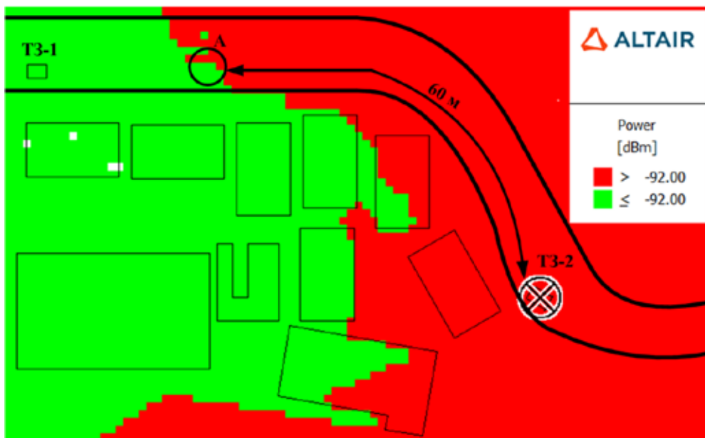
Рис. 3. Розподіл інтенсивності поля модуля OBU-301U при двох градаціях потужності
