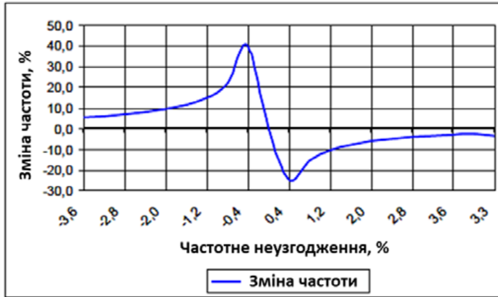
Рис. 4. Частотно-фазова характеристика запропонованої системи фазового автопідстроювання частоти
