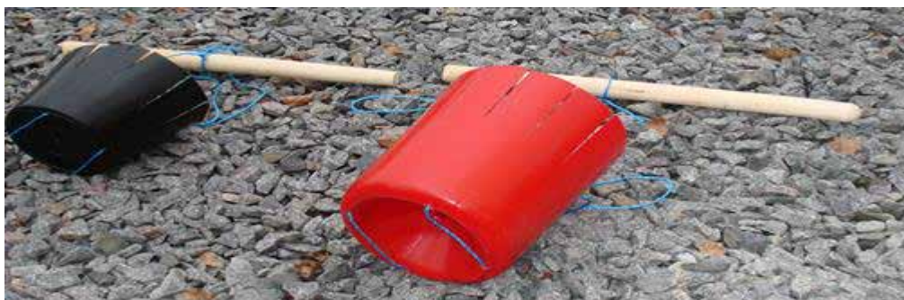
Рис. 2. Загальний вигляд пристроїв, які були використані при формуванні розосереджених зарядів (зліва – пристрій з плоским дном; справа – КЗП)
