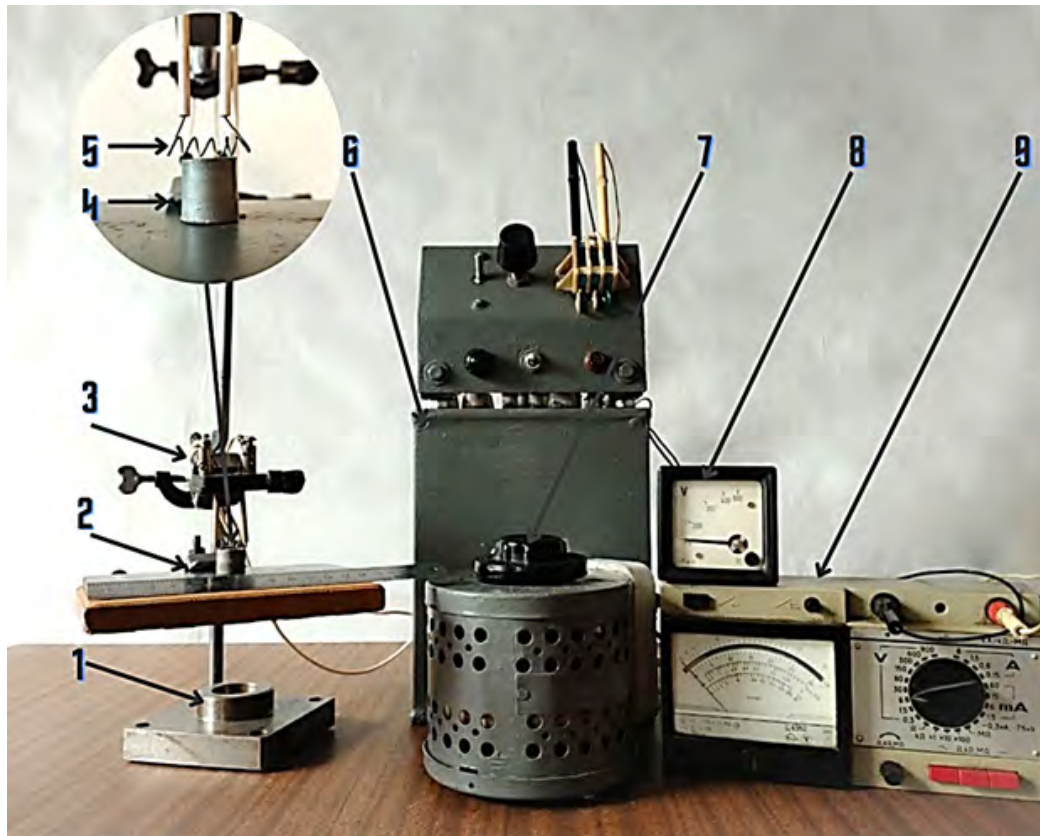
Рис. 1. Пристрій для ініціювання СВС-процесу: 1 – штатив; 2 – столик для встановлення зразків; 3 – діелектричний затискач зі спіраллю; 4 – зразок, спресований із шихти; 5 – спіраль; 6 – силовий трансформатор; 7 – лабораторний автотрансформатор; 8 – вольтметр первинної обмотки; 9 – вольтметр спіралі
