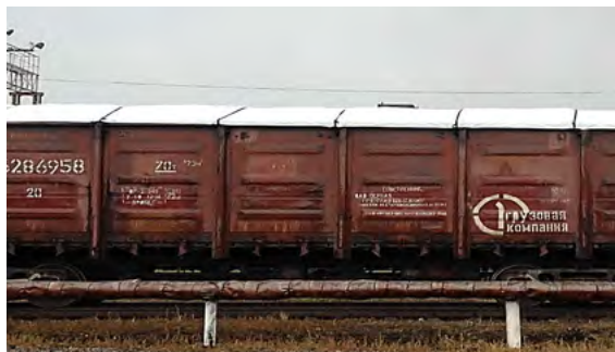
а – вагонне укриття з поліпропілену
