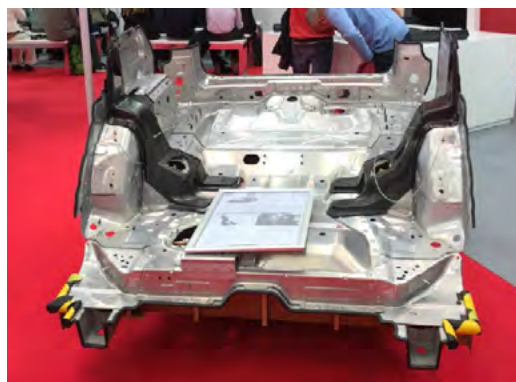
б – сталевий кузов автомобіля, посилений елементами із ПКМ
