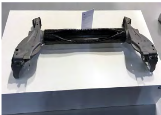
а – поперечна балка Magneti Marelli, посилена ПКМ
