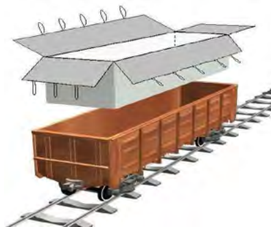
б – двошаровий вагонний вкладиш
